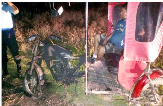
La mala instalación y el deterioro de la cablería del sistema eléctrico de una mototaxi, ocasionó un cortocircuito. Rápidamente, las llamas de fuego se
