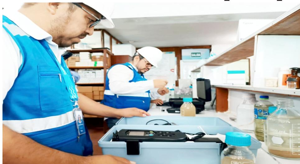
El equipo técnico de Sunass analizó diversos parámetros clave para la calidad del agua, como la turbiedad, el pH, el cloro residual libre y la conductividad. Además, verificó el estado de los componentes del sistema de desinfección, así como los registros de control relacionados
